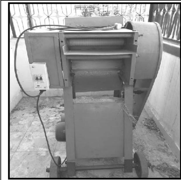
Fig. 7 : CRIJAF scutching machine (Nigam, 2018)
